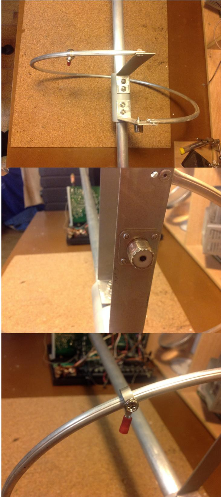
Per terminare il radiatore ho utilizzato sezioni decrescenti di tubo di alluminio, fissate tra loro tramite fascette stringi tubo di acciaio, facendo al termine di ogni sezione un taglio a croce in modo da poter garantire un corretto fissaggio
