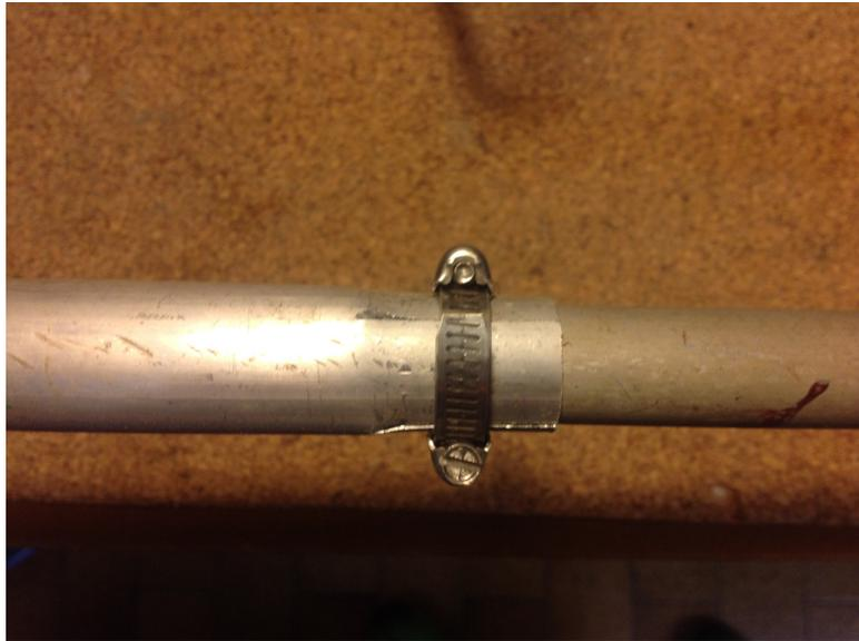
La lunghezza finale del radiatore calcolata è di 5300 mm ma in fase di costruzione ho tenuto l'ultimo tubo di alluminio di circa 1000 mm più lungo in modo da poter regolare la lunghezza del radiatore da 5000 mm a 6000 mm.
